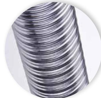
Tubo flexible de acero inoxidable de doble capa. INTERIOR LISO. De acero inoxidable AISI 316L o de acero inoxidable AISI 304. Se sirve en rollos de hasta 20 metros. Resistencia al fuego de hollín (G). Conducto ideal para entubados. Para calderas de tiro natural que trabajen en seco o en húmedo. Para ventilación interior y exterior.
